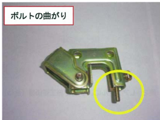
写真2 支持金物の変形
