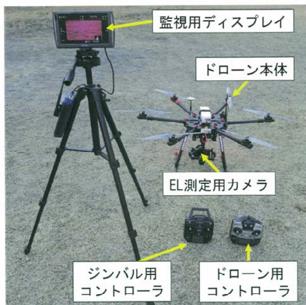
図6 ドローンEL測定システム外観
