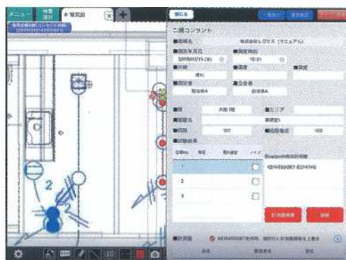
写真2 コンセント設備試験中画面（例）
